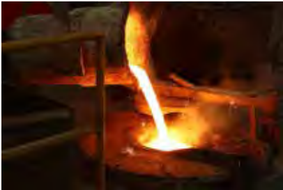
Pouring the Molten Iron
